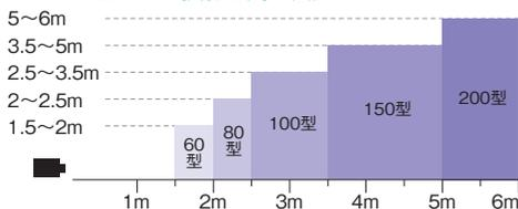
プロジェクターとスクリーンの間には、ある一定の距離をとる必要があります。映像が最も鮮明に映る距離は、プロジェクターの機種によって異なります。上記距離を参考に、実際に投影しながら距離を設定してください。
