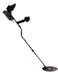
金属探知機 (ハンディー型) US-02RX 19,200 W440×D70×H30mm 感知距離<10円硬貨: 7cm、ナイフ: 15~20cm、 ピストル: 20~25cm> 電源: 9V電池1本
