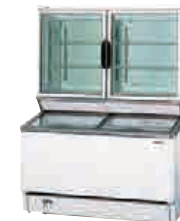
デュアルケース (80,000) US-24CS W1200×D797×H1615mm 最大消費電力：594W 電源：単相100V 上段：162ℓ (130mlアイスカップで540個) 下段：223ℓ (130mlアイスカップで791個) 熱線反射フィルム キャスター付
