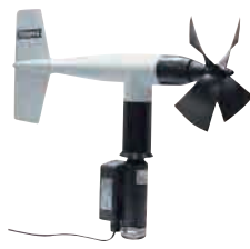
風向風速計 US-03RX 81,000 全高: 400mm 全長: 570mm 電源: リチウム電池 CFカード付
